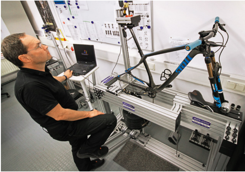
Durch flexende Sattelstützen sowie Material und Formgebung des Hinterbaus kann der Komfort eines Hardtails maßgeblich beeinflusst werden. Bereits bei 80 Kilo Belastung bieten komfortable Hardtails rund zehn Millimeter Federweg, wie die Messung auf dem Zedler-Prüfstand belegt.
