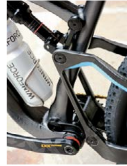
Konstruktiver Leckerbissen der Stoll-Bikes ist der antriebsneutrale, virtuelle Drehpunkt der Hinterradschwinge. Schön ist das Sicht-Carbon und die unsichtbare Kabelführung im Rahmen.
