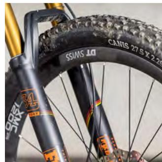
**Links** Selten gesehen: Die Bikeyoke Revive Variostütze verfügt über einen stufenlosen Hubbereich von 160 Millimetern. Die Bedienung erfolgt über einen Lenker-Remote. **Mitte** Das auf vier Drehpunkten basierende Hinterbausystem Pro10 ist eine Eigenentwicklung. Die Dämpfung übernimmt ein Fox Float Factory Series. **Rechts** Durch die Kombination von DT Swiss XMC 1200 Carbon Laufrädern und Onza Canis Reifen weist das Propain die geringste rotierende Masse auf.
