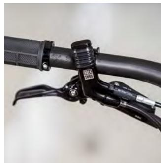
**Links** Mit einer Lefty 2.0 Carbon und satten 120 Millimeter Federweg ist das Habit ausgestattet, das das HollowGram Carbon Laufrad im Zaum hält. **Mitte** Ob Aluminium- oder Carbonrahmen, der Umlenkhebel am Federbein wird immer aus dem hochwertigen und belastbaren Material Carbon gefertigt. **Rechts** Über den RockShox XLoc Full Sprint Remote-Hebel am Lenker lässt sich zeitgleich das gesamte Fahrwerk straffen.
