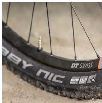
**Links** Die RockShox Reverb Stealth Variostütze mit 125 Millimeter Hub wird über einen Lenker-Remote-Hebel gesteuert. **Mitte** Je nach Dämpfer-Verschraubung am Umlenkhebel leistet der Hinterbau 115 bzw. 130 Millimeter Federweg. **Rechts** Der Schwalbe Nobby Nic kommt vorne in der Breite von 2,35 Zoll und in der weicheren Trail Star Gummimischung – für optimale Gripverhältnisse bei dennoch vernünftigen Rollwiderstand.
