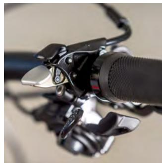
**Links** Das Ride-9 System ermöglicht neun unterschiedliche Positionen der vorderen Dämpferaufnahme. Dadurch lassen sich die Geometrie und das Fahrwerk individuell abstimmen. **Mitte** Rocky Mountain setzt in dieser Ausstattungsvariante auf einen klassischen 2x11-Antrieb von Shimano. **Rechts** Bequem vom Lenker aus lässt sich der Fox Float DPS Performance Elite Dämpfer in den drei verschiedenen Fahrmodi verstellen.
